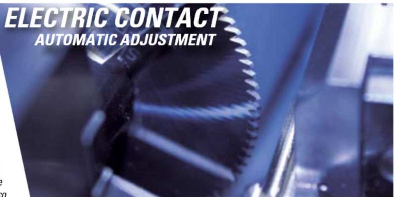
**LA FRESA DE METAL DURO INCORPORADO DA UN ACABADO FINO Y PRECISO EN EL CORTE DE LA LLAVE.** La Avantcode permite el uso de diferentes fresas y realiza diferentes tipos de corte como el normal, plano, ideal o vertical, pudiendo cortar otras llaves además de las llaves de serrata como llaves de casillero, FO-6P Ford ®-Tibbe ® o candados ABL-1, ABL-2...
